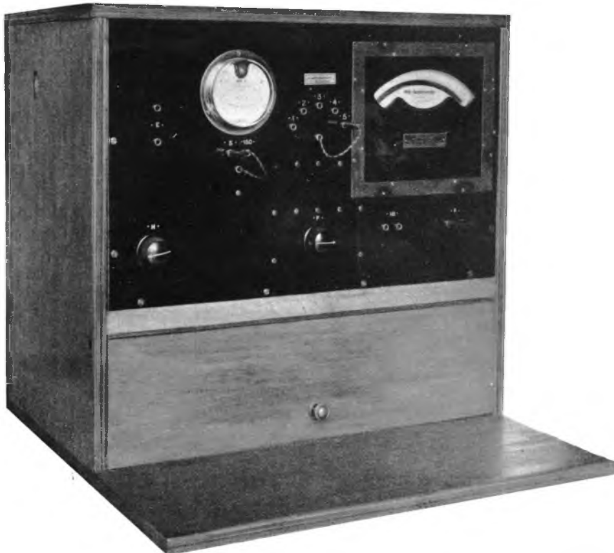
Fig. 5. Buitenaanzicht van den Lampvoltmeter
